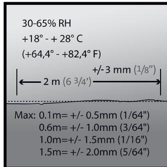
Zementestrich max. 2,0 CM% (1,8 CM% auf Fußbodenheizung)
